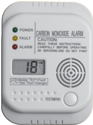
Мал. 20.2. Датчик умісту чадного газу в повітрі
