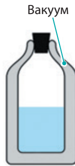
Посудина Дьюара: зовнішній вигляд і загальна схема
